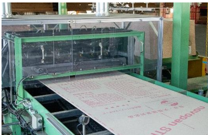
■ 表面処理/吹き付け（柱・間柱・筋交い・面材）
